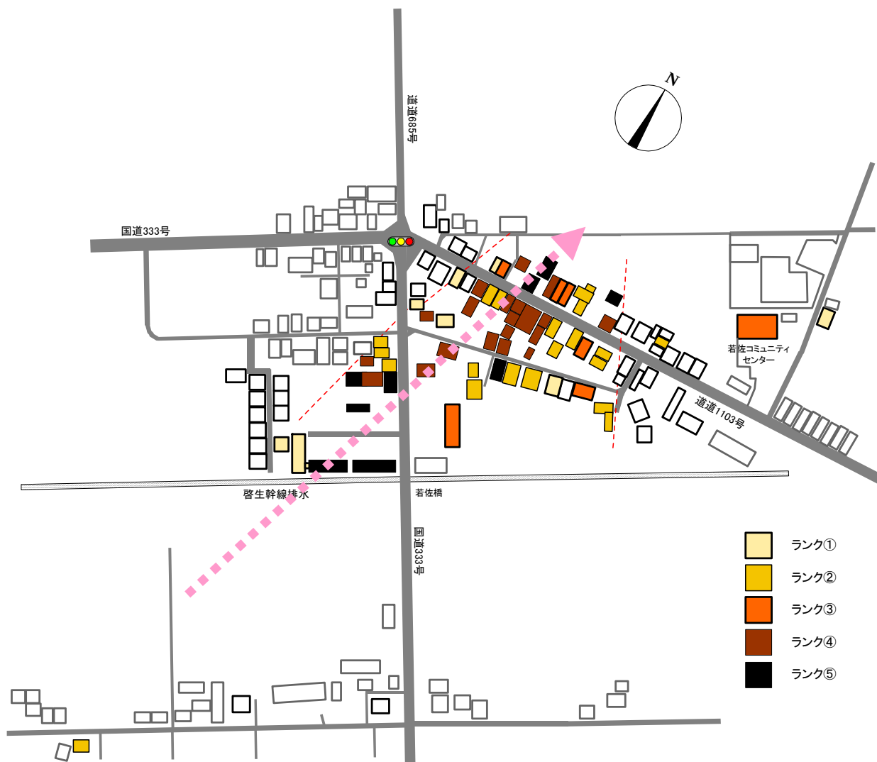
図6 強風被災度ランクによる若佐地区での強風被害分布（矢印は竜巻中心部の経路）
