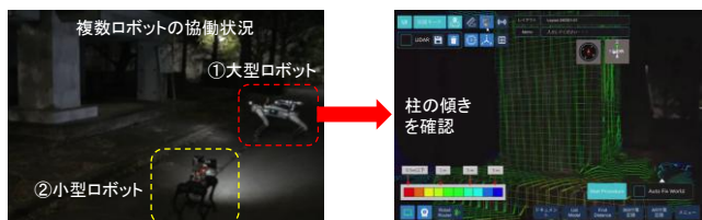
写真2 夜間時の複数ロボット・カメラによる遠隔臨場支援状況
